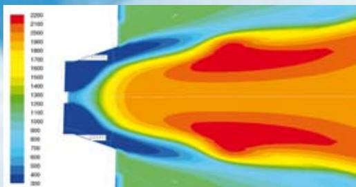
Вычислительная гидродинамика (CFD) является неотъемлемой частью исследований и разработок Oilon. Трехмерное проектирование и вычислительная гидродинамика дополняют друг друга при определении оптимальной конструкции горелок. Используя методы вычислительной гидродинамики можно рассчитать, например профили потока и потери давления воздуха горения, уровень выбросов, а также распределение температуры в топке.
